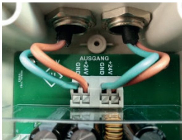
(+24V und GND(Masse) zu den jeweiligen Leuchtenkörpern)
